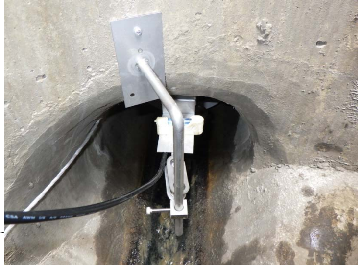
▲横打超音波式水位計設置状況
